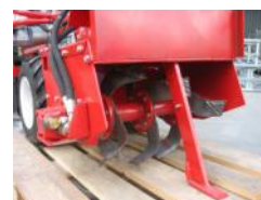
La machine est pourvue de couteaux durcis
